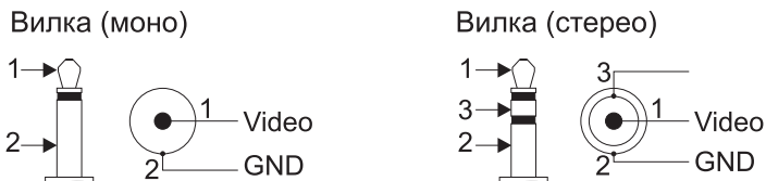
Рисунок 3 - Схемы распайки вилки для гнезда “Выход видеосигнала”
